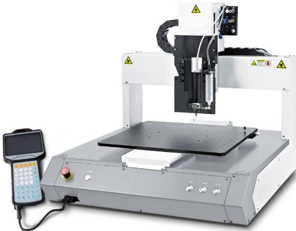
Pour les fabricants de petites séries, la série MYSmart propose une sélection de robots de distribution de table robustes avec différents niveaux de capacités.
